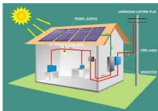
**Gambar 2. Mekanisme Konversi Energi Surya**
