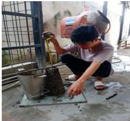
Gambar 2 Pengujian Slump Test
